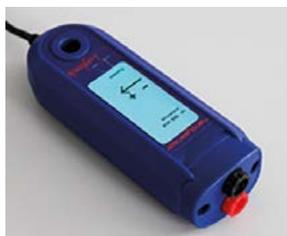
**Sensor de voltaje  $\pm 20\text{V}$**
