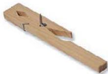
**Pinza para tubos de ensayo**
