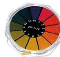
Precisión: 1, rollo con escala colorimétrica.
