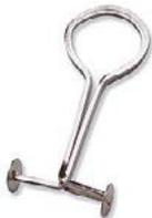
**Pinza para tubos de ensayo**
