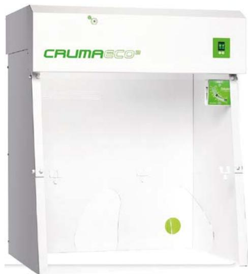
Cabina de filtración de gases sin conducto. Manipulaciones de reactivos o compuestos químicos a temperatura ambiente o moderada en todo tipo de laboratorios: análisis, investigación, control de calidad, clínicos, de enseñanza, ... incluye de serie:
