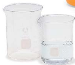
Vaso de precipitados. Vidrio. Forma baja.
